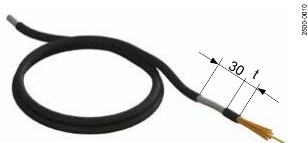
Imaginea 24 Înainte de a-l conecta la releta de conexiuni, îndepărtați izolația cablului CEM pe 30 mm. Dimensiunea „t” corespunde aproximativ distanței dintre brățara de fixare și borna cablului
