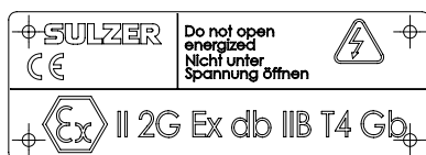
Imaginea 9b Plăcuța de fabricație ATEX
